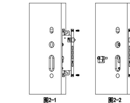
2-3. 后锁安装反锁拨片（反锁拨片和开口锁在配件包中），并根据门厚确定Φ方轴长度、锁芯传动轴长度、反锁拨片长度。
