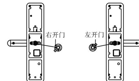
1.4.3 后锁面把手换向时，取出换向螺丝，将把手旋转180°，然后锁回换向螺丝即可。
