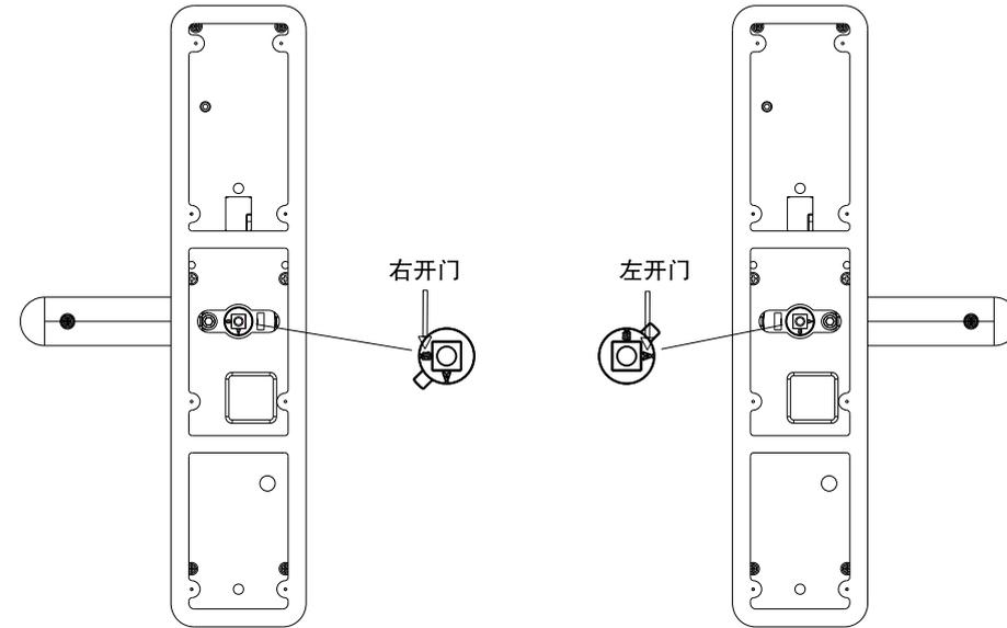
1.2.3 后锁面把手换向时，取出换向螺丝，将把手向上旋转180°，然后锁回换向螺丝即可。
